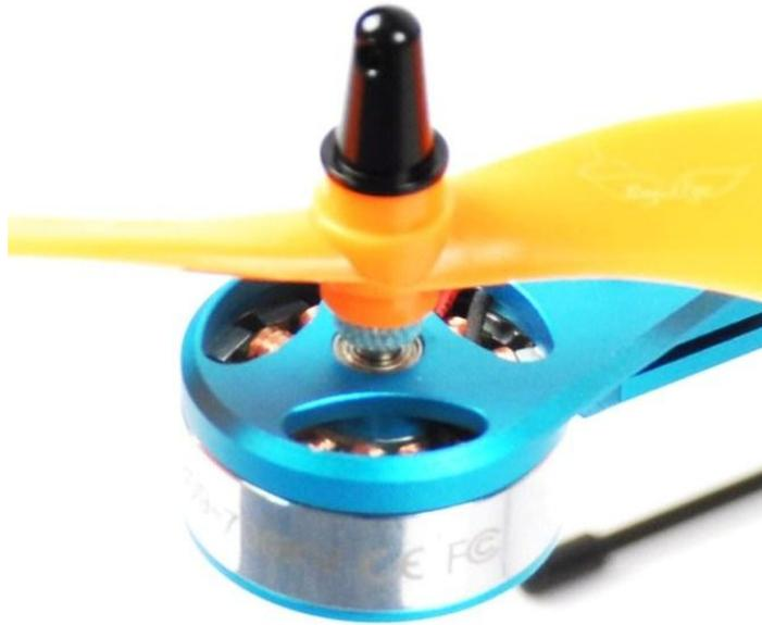
XN-III 使用 4 支 12 寸正反专用对桨，桨轴内嵌铜质螺纹套，和电机轴匹配为旋紧固定方式，再加以铝合金桨夹，确保稳固安全。逆时针转动的为正桨，顺时针转动的是反桨。螺旋桨的安装如下图所示，前后为正桨，左右是反桨，不可装错。**为了安全，先不要装螺旋桨，待设置完成后再安装。**
